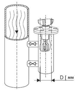
Установка в байпасе (Внутренний диаметр = \_\_\_\_\_ мм)
